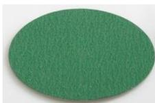
Ideal para el amolado de superficies de acero inoxidable y de costuras de soldadura. El tejido portante es extremadamente resistente al desgarre. Un calentamiento reducido y tiempos de vida útil mayor son la base para un mayor rendimiento. A utilizar con un plato abrojo de un máx. Ø 125 mm.
