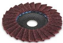
Arandela elástica dentada de napa para trabajos de lijado, limpieza y acabado en acero fino, acero, aleaciones de titanio, metales ligeros, metales compuestos y plásticos. Eliminar colores de revenido, corrosión ligera, cascarillas y arañazos. Preparar las costuras de soldadura, lijar y pulir.
