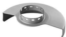
Cubierta de protección para el amolado con sistema de alojamiento nuevo. Seguro contra torsión con ajuste de posición, montaje y desmontaje sin uso de herramientas. No compatible con la versión anterior. Adecuado para todos los equipos nuevos de FLEX con número de pedido 406.XXX.
