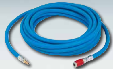
■ Manguera de aire de alta calidad para la conexión a pistolas de pintura Diámetro interior 9 mm, 10 m largo, con acoplamiento rápido y niple, antiestática, libre de sustrancias perturbadoras para pinturas, resistente a presión de 20 bar, alta seguridad contra reventones. Ref. 53090
