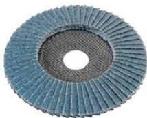
Ideal para trabajos de amolado en metales, acero inoxidable, acero en aleación y sin ella, metales ligeros, metales no ferrosos, fundición de hierro y para el trabajo en costuras soldadas. Para eliminar puntos y materiales excedentes de soldaduras, matar cantos y redondear. Se garantiza una alto rendimiento de desbastado y un trabajo libre de esfuerzos sin lubricativo adicional.
