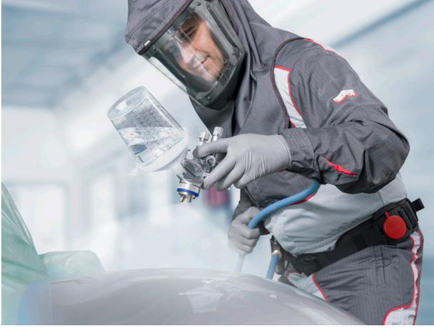
Sin adaptador – los depósitos desechables SATA RPS encajan perfectamente en la SATAjet 5000 B – eso reduce el peso y la limpieza
