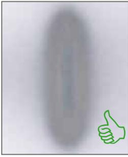
La suciedad o daños en los elementos de boquilla pueden llevar a abanicos incorrectos. Por lo general la suciedad se puede eliminar fácilmente – el manual SATA detallado "Limpieza y mantenimiento de pistolas de pintura" debe deduzirse en: [www.sata.com/firstaid](http://www.sata.com/firstaid)
