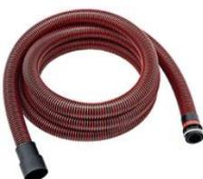
Diámetro interior de 32 mm, 4 m, con acoplamiento universal al aparato, sistema de clip y adaptador universal (320.188), antiestático. Incluye regulación de aire adicional para reducir lo necesario la presión de aspiración negativa.
