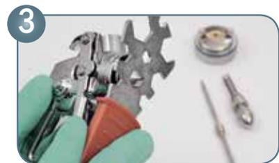
Por último, desenroscar la boquilla de pintura con la llave de anillo integrada en la herramienta Universal.
