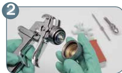
A continuación, desmontar la boquilla de aire.
